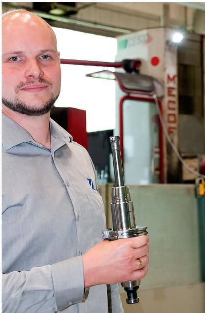
**Sören Leinweber und der montierte Wendepplatten-Tonnenfräser GF1:** In Kombination mit der passenden Frässtrategie lassen sich die Fräsprozesse signifikant beschleunigen. (© MMC Hitachi Tool)
