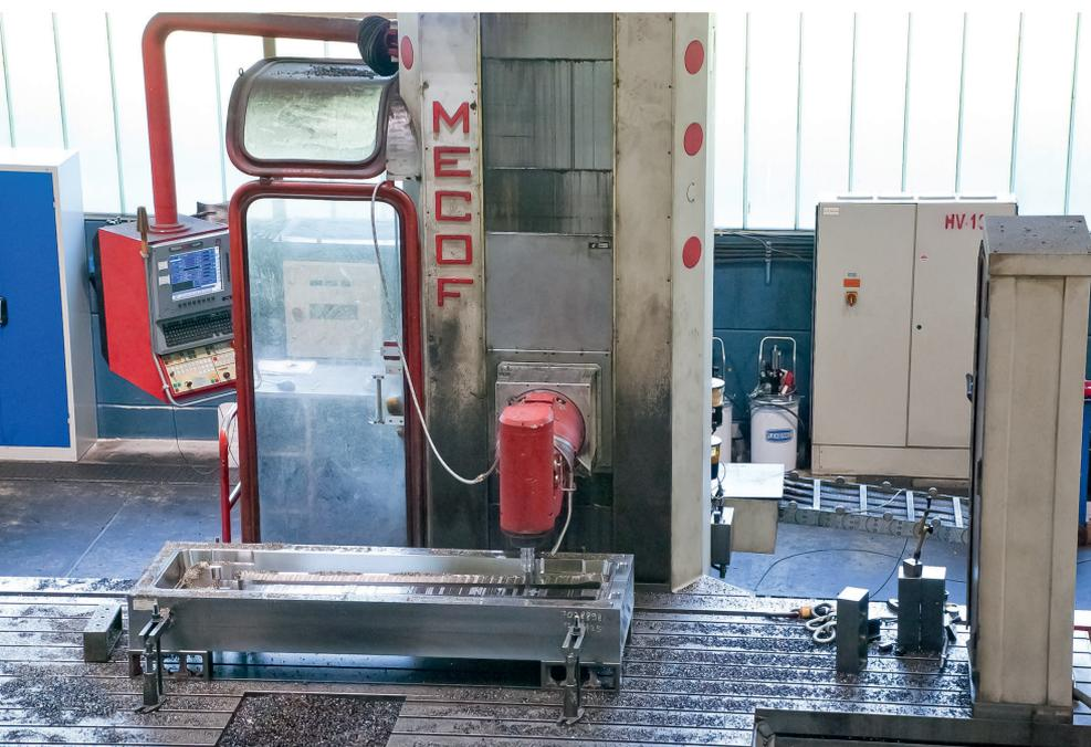
**Fräsen im XL-Format:** Auf der großen Mecof-Fahrständermaschine sorgt der GFI beim Abzeilen der Schrägen für enorme Zeitvorteile. (© MMC Hitachi Tool)
